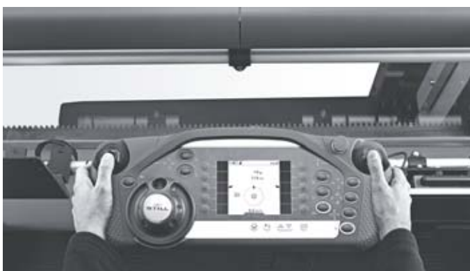
Painel de comando compacto e ergonómico com ecrã a cores e informações para o condutor
