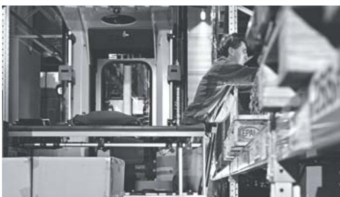
Barreira própria para inclinação, que permite um picking ergonómico até ao fim da paleta
